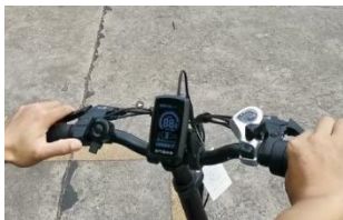
Krok 3: Włącz wyświetlacz w tym samym czasie, Krok 4: Zwolnij drążek przepustnicy i lewy hamulec, przytrzymując drążek przepustnicy i lewy hamulec przez 8 sekund. i zakończ.
