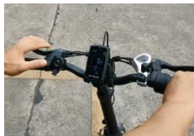
Krok 3: Włącz wyświetlacz w tym samym czasie, Krok 4: Zwolnij drążek przepustnicy i lewy hamulec, przytrzymując drążek przepustnicy i lewy hamulec przez 8 sekund. i zakończ.
