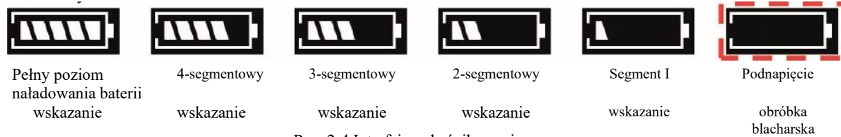
Rys. 2-4 Interfejs wskaźnika poziomu naładowania baterii
